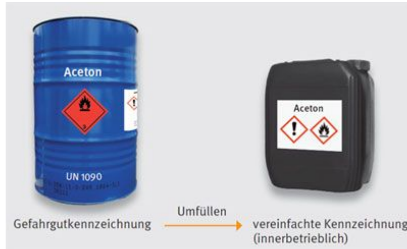
Abbildung 13: Übertragung der Gefahrgutkennzeichnung (Transportverpackung) auf vereinfachte Kennzeichnung (innerbetrieblich verwendete Behälter) bei Umfüllvorgängen
