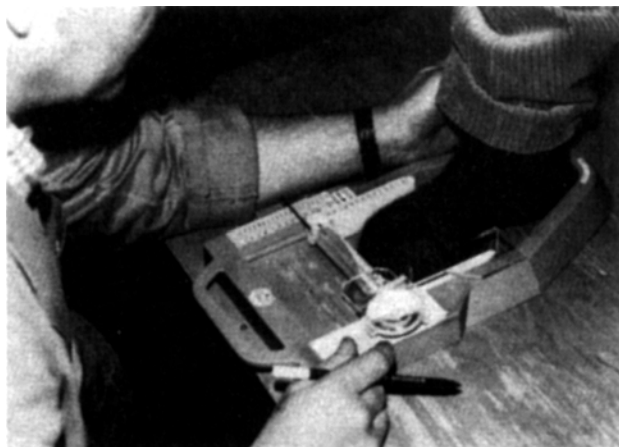
Bild 4: Vermessen des bekleideten Fußes nach Länge und größter Breite mit einem einfachen Messgerät
