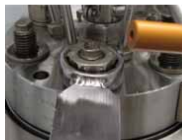
Abb. 3: fester Sitz des Ringschlüssels
